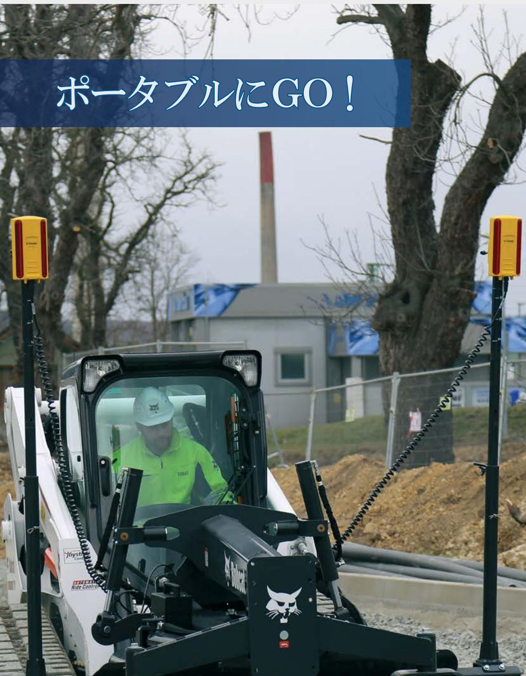
Trimble Earthworks GO! は、平坦な面や単純勾配のグレーディングを必要とする一般的な建設現場に最適です。レーザーテクノロジーを利用して、リアルタイムな位置情報を算出しますので、より迅速で正確な整地が行なえます。
